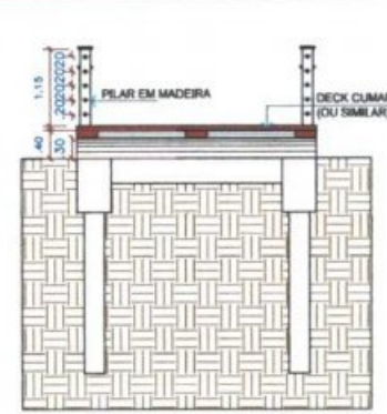
CORTE PONTE BB Escala 1/50
